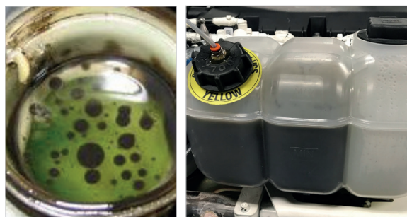
Verunreinigungen im Kühlkreislauf
